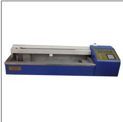
Дуктилометр автоматический **ДА-01-100** предназначен для определения растяжимости нефтебитумов. Дуктилометр позволяет определить максимальную длину, на которую может растянуться без разрыва битум, залитый в специальную форму, раздвигаемую с постоянной скоростью при заданной температуре.
