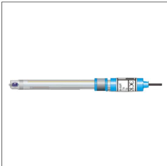
Предназначен для большинства случаев лабораторного анализа. Наиболее компактный вариант, объединяющий три устройства (измерительный электрод, электрод сравнения и термодатчик) в одном корпусе. Одинаковая температурная инерционность электродной системы и встроенного термодатчика позволяет повысить точность измерений в условиях изменяющейся температуры анализируемого раствора. Рекомендуется для работы с переносными приборами, особенно для измерений при пониженной температуре.
