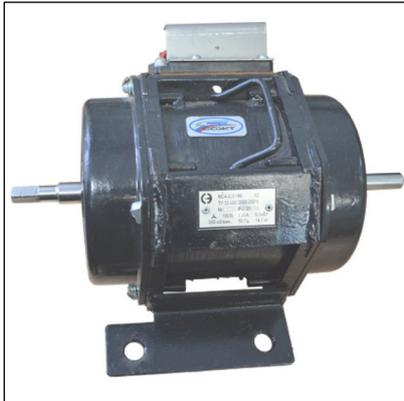
Асинхронные, реверсивные, трехфазные электродвигатели переменного тока **МСА** предназначены для эксплуатации на железнодорожном транспорте в повторно-кратковременном режиме (S3 ГОСТ 183) с продолжительностью включения ПВ=15%.
