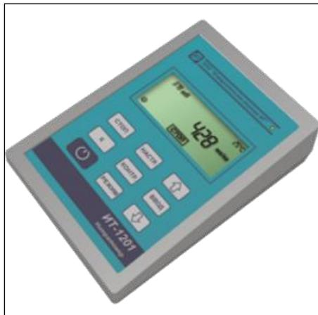
Нитратомер предназначен для измерений показателя активности нитрат-ионов ( $pNO_3$ ), содержания нитрат-ионов или нитратного азота (г/кг или г/л) в различных объектах в соответствии с методиками, предусмотренными нормативными документами РФ и стран СНГ, а также температуры ( $t$ ) водных растворов.
