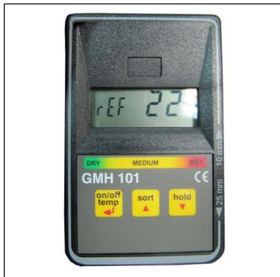
Влагомер древесины и строительных материалов **GMH-101** предназначен для измерения влажности пиломатериалов, ДСП, фанеры, дров или деревянных брикетов.
