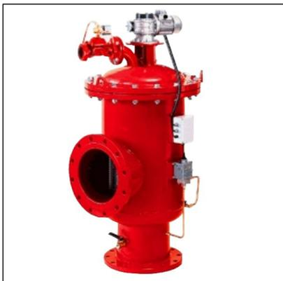
Фильтры серии **ABF** являются прочными фильтрами, оснащенными встроенным автоматическим механизмом самоочистки для очистки фильтрующей сетки в процессе работы. Фильтры ABF предназначены для работы в тяжелых условиях с высоким содержанием взвесей. ABF осуществляют фильтрацию от 3500 до 200 микрон и выпускаются с впускным и выпускным диаметром от 8" до 14".
