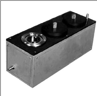
Устройство П1-01 предназначено для градуировки и поверки (калибровки) вискозиметров ВВН-8, находящихся в эксплуатации.
