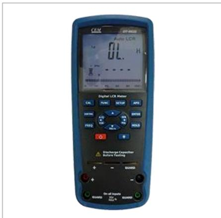
DT-9935 – профессиональный LCR-метр с автоматическим выбором режима измерения – L, C или R. Кроме того, прибор дополнительно измеряет добротность, коэффициент затухания, тангенс угла диэлектрических потерь (Q, D,  $\theta$ ). Высокая точность достигается 4-проводной схемой измерения.
