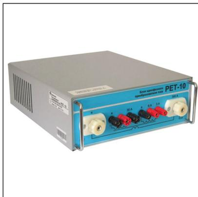
Блок **РЕТ-10** предназначен для масштабирования с высокой точностью одного из выходных токов токовых каналов с коэффициентами передачи 10, 5 и 0,1 и обеспечивать работу приборов РЕТОМ-51 и РЕТОМ-61 в широком диапазоне токов и нагрузок.
