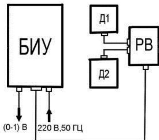
Каждый датчик представляет собой две параллельные металлические полосы, образующие конденсатор, и измерительный блок. Изменение электрической емкости конденсатора (датчика) функционально связано с изменениями величины влажности контролируемой культуры. Измерительный блок датчика (Д1), (Д2), преобразует значения емкости конденсатора в сигнал измерительной информации, который по соединительному кабелю через расширитель входа (РВ) передается в блок индикации и управления (БИУ).
