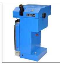
Колориметр КНС-1 предназначен для инструментального обеспечения ГОСТ 2667 и используется для контроля цвета светлых нефтепродуктов – топлив и растворителей. Цвет зависит от степени очистки и во многом определяет качество нефтепродуктов и изменение их свойств при длительном хранении.
