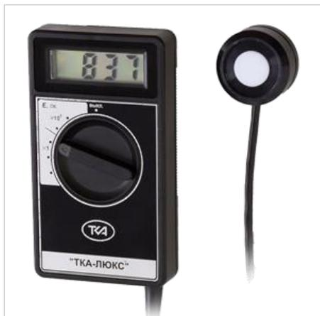
ТКА-Люкс люксметр предназначен для измерения освещённости в видимой области спектра, создаваемой искусственными или естественными источниками, расположенными произвольно относительно приемника.
