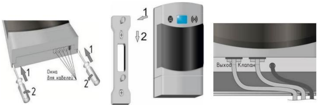
а) снятие крышки клеммного отсека
