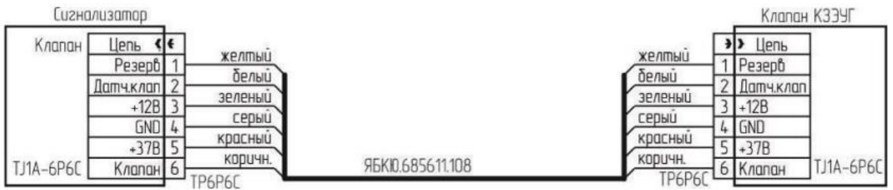
Рис. 7. Схема подключения клапана КЗЭУГ с разъемом TJ1A-6P6C
