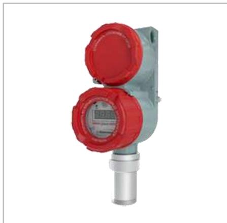
Газоанализаторы серии ДАФ-М предназначены для контроля атмосферы рабочей зоны предприятий. Определяют пары таких веществ как: ацетон, бензол, гексан, толуол, фенол, этанол, дизельное топливо, уайт-спирит, циклогексан, стирол, бензин.
