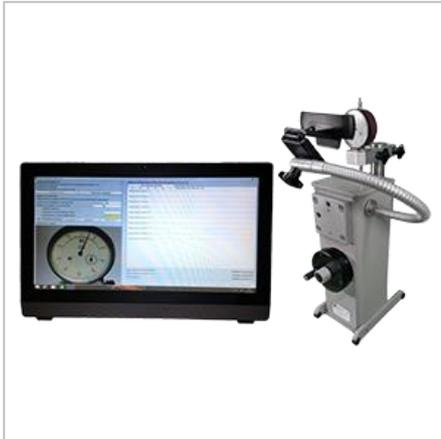
Прибор ППИ-50 предназначен для поверки индикаторов часового типа ИЧ-02, ИЧ-05, ИЧ-10, ИЧ-25, ИЧ-50, рычажно-зубчатых индикаторов ИРБ и нутромеров индикаторных с ц.д. 0,01 мм с диапазоном измерения от 6 до 160 мм в измерительных лабораториях.
