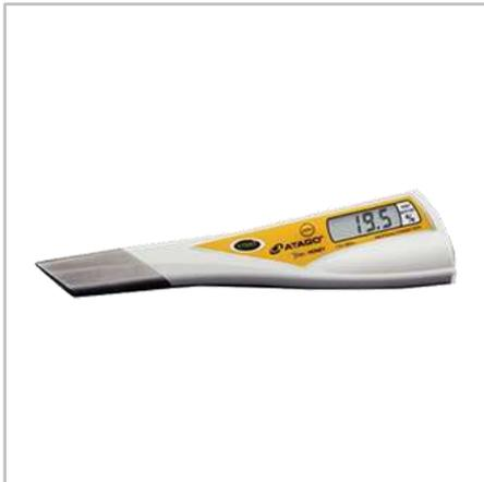
Рефрактометр PEN-HONEY предназначен для измерения процентного содержания влаги в мёде.
