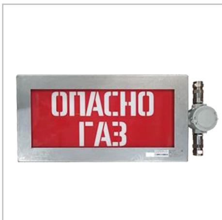
Взрывозащищенные световые табло ПГС-ИТ31 из нержавеющей стали применяются в качестве информационных указателей, для выдачи сигналов светового оповещения внутри помещений и на открытых промышленных площадках во взрывоопасных зонах, в присутствии взрывоопасных и воспламеняемых газов с целью регулирования поведения человека как в штатном режиме, так и при возникновении чрезвычайных ситуаций.
