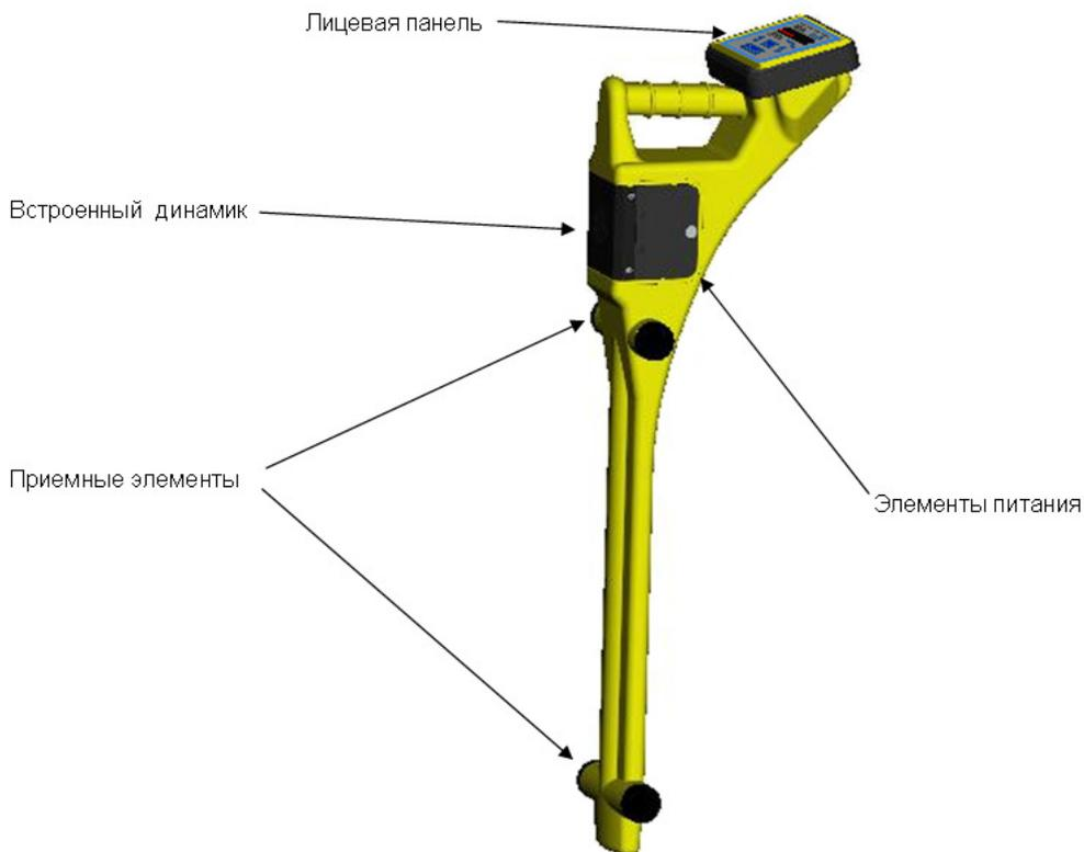
Данный прибор позволяет выполнять прямое измерение глубины залегания коммуникации и величины текущего через неё переменного тока. Поддерживаемые режимы измерения следующие:
