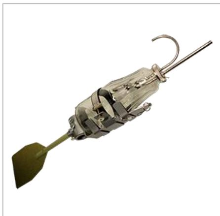
Батометр–бутылка ГР-16М предназначен для взятия проб воды со взвешенными наносами при длительном наполнении емкости.
