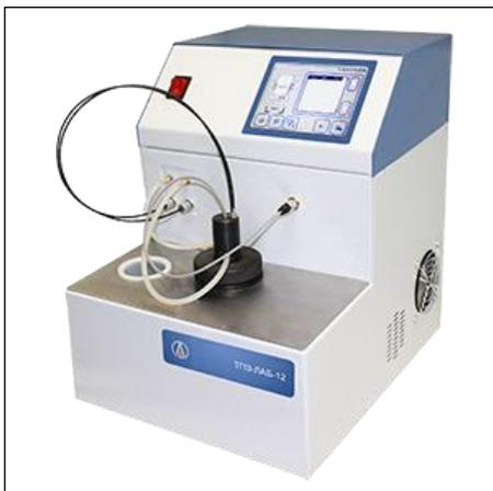
Автоматический аппарат ТПЗ-ЛАБ-12 предназначен для проведения экспресс анализа по определению температуры помутнения и застывания нефтепродуктов в соответствии со стандартами ASTM D6749, ASTM D7683.
