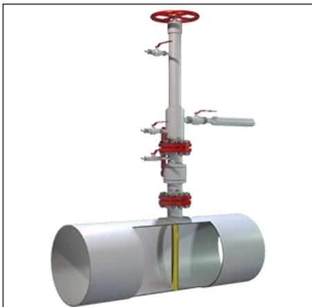
Пробозаборные устройства ЩПУ-2 предназначены для отбора высокопредставительной пробы любой жидкости, газожидкостной или газовой среды из трубопроводов, а также осуществления монтажа или осмотра устройства при наличии избыточного давления в трубопроводе; позволяют спроектировать и обеспечить оптимальные режимы работы УУ, в т.ч. СИКН(С), и ручного отбора пробы.
