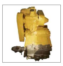
Буровой насос «НБ-160/63» предназначен для нагнетания промывочной жидкости в скважину с целью ее промывки при геологоразведочном бурении глубиной до 2000 м, осуществляемом вращательным и вращательно — ударным способами.
