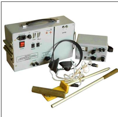
Аппаратура **АНТПИ-2** служит для проверки изоляции подземных газопроводов (определение наличия электрического контакта труба-земля и его местонахождения), определения трассы металлических подземных газопроводов и спутника неметаллических газопроводов, местонахождения смежных коммуникаций (электрический кабель, водопровод, теплотрасса и др.)
