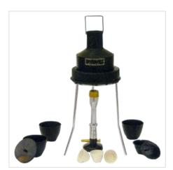
Аппарат ТЛ-ПХП ппредназначен для определения коксуемости масел, топлив и других нефтепродуктов по ГОСТ 19932, ASTM D 189, ISO 6615 путем их сжигания при определенных условиях и количественного определения углистого остатка - кокса.
