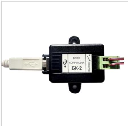
Блоки коррекции серии БК предназначены для выдачи сигнала на вход коррекции первичных часов серий ДИХРОН или ДИХРОН-С, программируемых реле времени ПИК-2ТК, РВПГ-2, ПРВП-2, РАСТР-2 или СПРВ-1, а также других подобных устройств.
