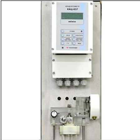
Серия стационарных программируемых кондуктометрических приборов «КАЦ-037» предназначена для измерения параметров обессоленной воды или водных растворов низкой концентрации. Допустимое расстояние до датчика 500м при сопротивлении жил кабеля связи до 30 Ом.
