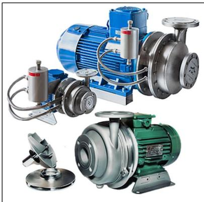
Химические электронасосы **ХМ** предназначены для перекачивания химически активных жидкостей (кислот, щелочей, растворов солей), обеспечивающих скорость проникновения коррозии в материал проточной части (сталь 12Х18Н10) не более 0,1мм/год. Плотность — до 1,85г/см<sup>3</sup>.
