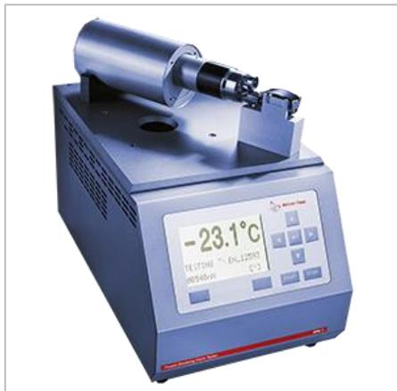
Анализатор хрупкости определяет хрупкое поведение битумов при низких температурах.
