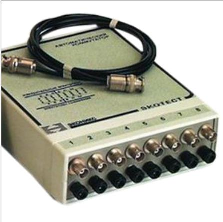
Автоматический коммутатор на 8 каналов предназначен для совместного использования с прибором Экотест с целью увеличения количества ионометрических каналов.
