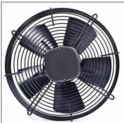
YWF электровентилятор осевой малошумный обладает компактной конструкцией корпуса с лопатками из углеродистой стали с лакокрасочным покрытием и электродвигателем с внешним ротором. Электровентилятор удобно монтируется в стеновые проемы или другие несущие конструкции, устанавливается в любом положении, имеет ресурс работы не менее 40 000 часов и класс защиты электродвигателя IP 44.
