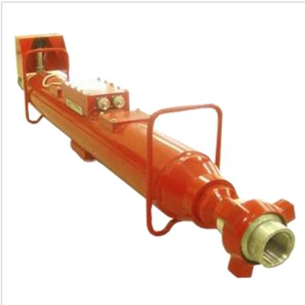
Плотномер вибрационный ПВ-В-75-103-01 предназначен для измерения плотности, температуры (опционально) и давления (опционально) жидкости, а также для вычисления расхода и количества жидкости с использованием внешних первичных преобразователей расхода с частотным выходом.
