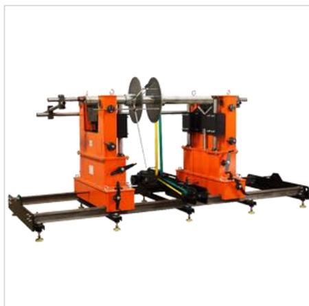
Балансировочные станки типа СБУ зарезонансного типа рассчитанны на массу роторов от 0,05 до 3000 кг.
