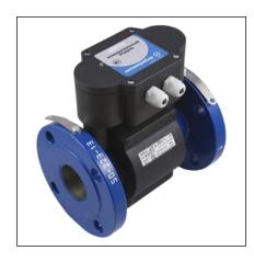
Измерительный модуль М121-И6 представляет собой составную часть теплосчетчика МКТС и предназначен для измерения расхода, температуры и давления жидкости в трубопроводах. Основу измерительного модуля составляет электронный блок, к которому подключаются первичные преобразователи расхода (один), температуры (до двух) и давления (не более одного).
