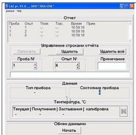
Программа LAZ предназначена для работы с аппаратом ЛАЗ-М(1,2,3).
