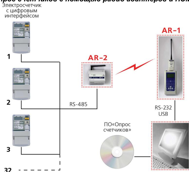
Режим функционирования радиоадаптеров - прозрачный, обеспечивающий пересылку больших пакетов данных при одинаковых скоростях в последовательном интерфейсе и RF-канале. Прозрачный режим протокола радиосвязи позволяет передавать данные без дополнительного обрамления вспомогательной служебной информацией, что позволяет встраивать радио адаптеры в существующие проводные каналы связи.
