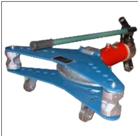
Трубогиб гидравлический ТГ-4 сгибает металлические трубы до угла в 90 градусов, не допуская их деформации. Его используют для монтажных работ в сфере энергетики и ЖКХ, предприятий нефтепереработки и строительстве. Не требует наполнения стальной трубы песком или другим составом при монтаже и сгибании. Рабочие температуры – от -10 до +40 градусов по Цельсию.
