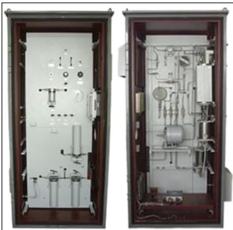
Газоаналитический комплекс СГК-75 предназначен для контроля кислорода в колоннах окисления при производстве битума.
