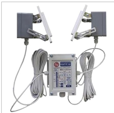
Сигнализаторы уровня PCY-1P, PCY-1PA предназначены для контроля пороговых уровней высокотемпературных (до +200°С) неабразивных сыпучих материалов (зерно в сушилке, силикатные смеси, керамзит и пр.) в самотёке, бункере или его коническом сходе диаметром (шириной) до 8 метров. Продукт может содержать агрессивные примеси (например, негашёную известь).
