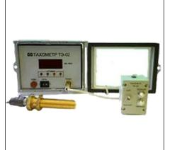
Тахометр предназначен для измерения частоты вращения одно- и многовальных машин и агрегатов.
