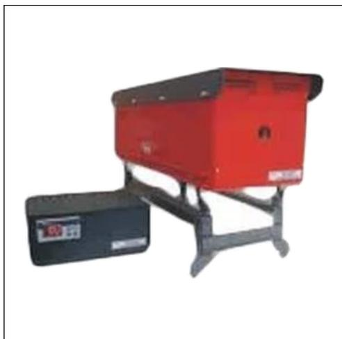
Излучатель в виде модели абсолютно черного тела ОИ-АЧТ-Гелиос предназначен для настройки и градуировки средств бесконтактного измерения температуры (пирометров, линейно-сканирующих пирометров и измерительных тепловизоров) в диапазоне температур от плюс 800 до плюс 1500 °С в лабораторных условиях.
