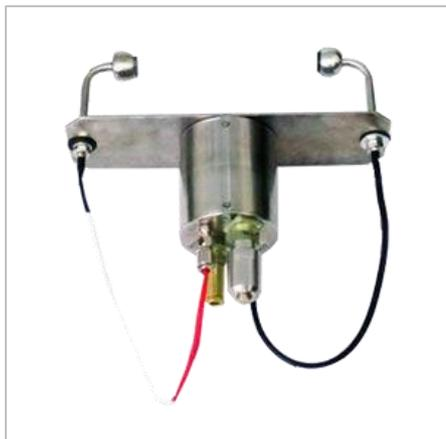
Комплекс измерения параметров воздушного потока МВ-22 предназначен для автоматического непрерывного измерения параметров воздушного потока в вентиляционных системах различных устройств и сооружений АЭС.
