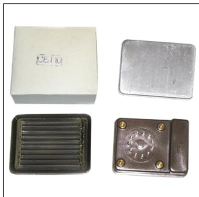
Торцевые счетчики СБТ 9, СБТ 10, СБТ 11, СИ19БГ, СИ 8БМ предназначены для регистрации мягкого бета- и гамма- излучений.
