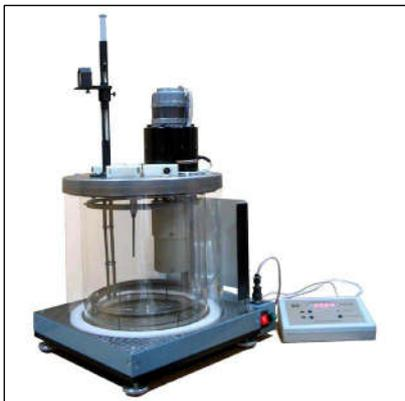
Термостат «ЛТН-03» используется для обеспечения рабочего режима стеклянных вискозиметров при определении вязкости нефтепродуктов в области положительных температур по ГОСТ 33. Вязкость нефтепродуктов относится к числу основных показателей, определяющих качество нефтепродуктов, а определение вязкости является одним из наиболее часто выполняемых анализов при контроле качества топлив и масел.
