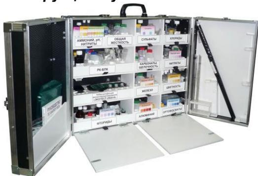
Лаборатория НКВ-12 может легко разворачиваться и применяться в полевых условиях, размещаться на собственных съемных ножках или закрепляться на стене.
