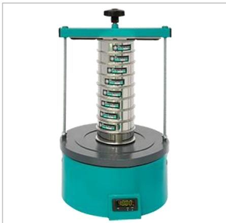
Вибросито или ситовой анализатор А-12, А-20, А-30, А-50 предназначены для сухого рассева сыпучих материалов в периодическом режиме.
