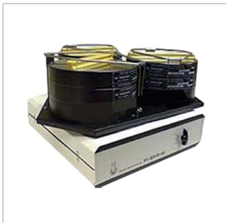
Рассевы У1-ЕРЛ-10 предназначены для контроля крупности сыпучих продуктов, сырья, материалов, зерна, крупы, муки и комбикормов до и после дробления, измельчения и обогащения.
