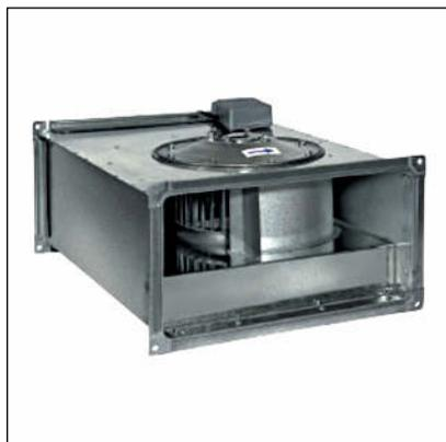
VCP электровентильатор обладает компактной конструкцией корпуса из оцинкованной стали, лопатками, загнутыми вперед и трехфазным (однофазным) асинхронным электродвигателем с внешним ротором. Электровентильатор устанавливается в любом положении, имеет возможность регулировки скорости и класс защиты электродвигателя IP 44.
