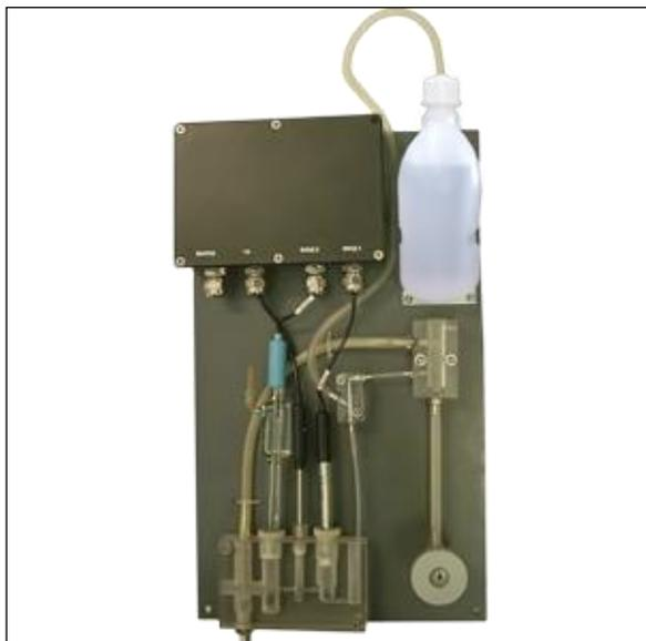
Блок гидравлический (гидроблок) представляет собой устройство, включающее в себя проточную измерительную ячейку, с гнездами для установки электродов и термодатчика, систему стабилизации скорости потока пробы и ее подщелачивания, а также коммутационный блок для подключения датчиков к преобразователю.
