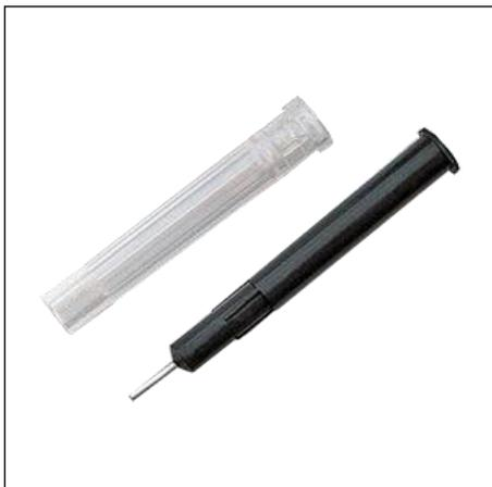
Амальгамный электрод (АмЭ) представляет собой полимерный стержень с запрессованной серебряной проволокой, покрытой амальгамой серебра. На стадии изготовления электрода поверхность серебряной проволоки подвергается специальной обработке, что улучшает аналитические характеристики амальгамного электрода и облегчает формирование амальгамы серебра.
