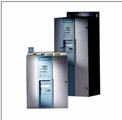
Семейство комплектных микропроцессорных электроприводов постоянного тока 6RA70 имеет подходящие типы для широкого спектра задач: от высоко комплексных приводных задач до стандартных решений. Приводы высоко динамичны: время возбуждения либо время нарастания вращающего момента находится в пределах до 10 мс. И это в диапазоне мощностей от 6.3 до 2000 кВт для запитки через якорь или внешним магнитным полем, для приводов, работающих в одном или четырех квадрантах.
